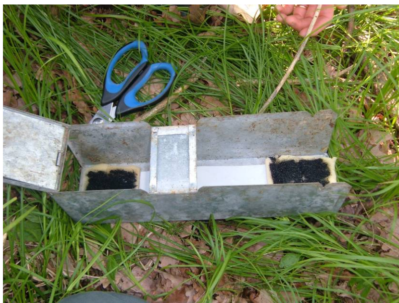
Fig. 4.7/A – Interno di una footprint trap utilizzata per il monitoraggio: è visibile il foglio di carta adesiva nel centro per la raccolta delle impronte e, ai lati, i due tappetini in gommapiuma imbevuti di inchiostro
