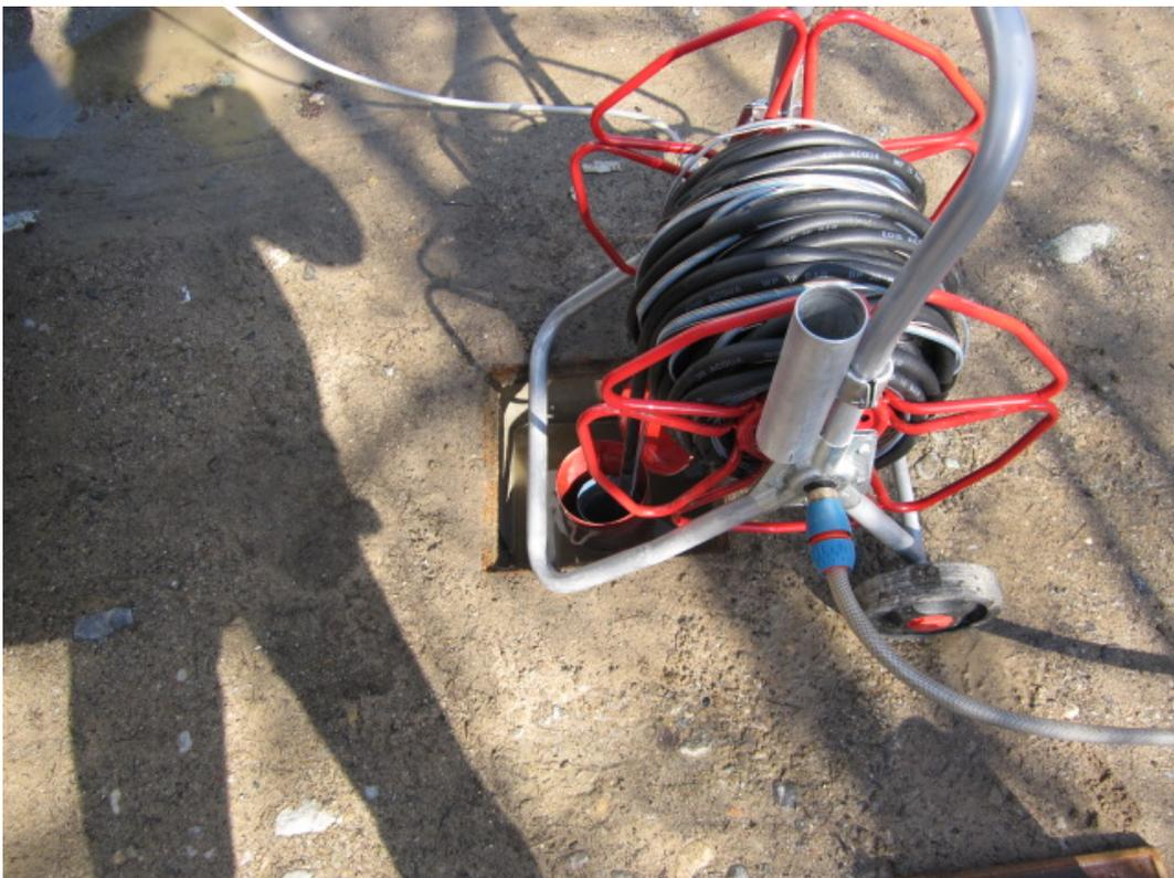
FOTO 2 Vista particolare del piezometro
