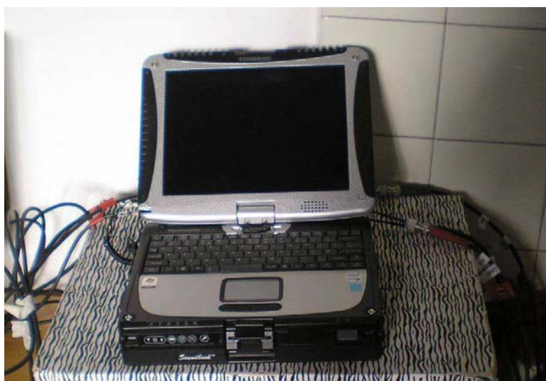
Figura 3.3: Analizzatore Sinus mod. Soundbook S/N 6255
